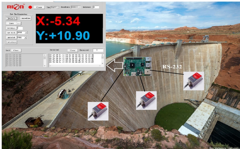
Сурет 2. Бөгет құрылыстарын қашықтықтан бақылау құрылғысының жұмыс принципі
